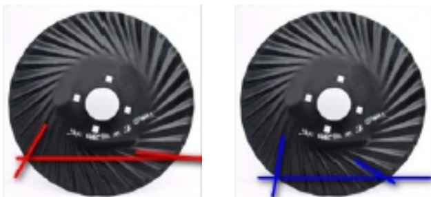
Imagen 5. Efecto de la profundidad de la cuchilla sobre el trabajo de la ondulación. Izquierda, exceso de profundidad, afectando al corte de residuos. Derecha, correcta profundidad, maximizando corte de residuos.
