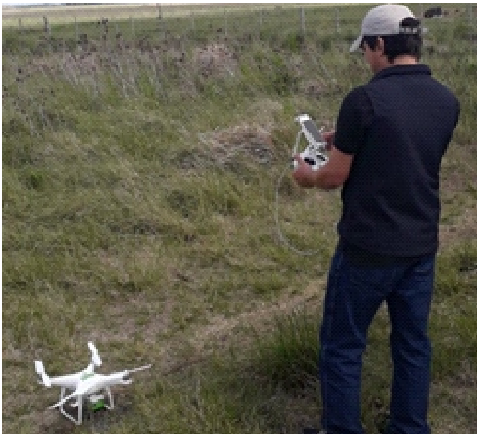
Figura 1. Drone DJI Phantom utilizado para medir IVN en una pastura de agropiro alargado.
