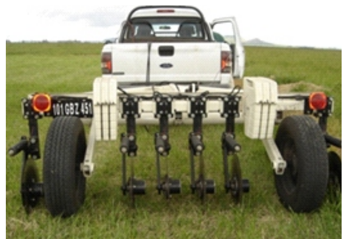
Figura 1. Rastra Veris 3100 realizando el relevamiento de Cea en una pastura de festuca alta.
