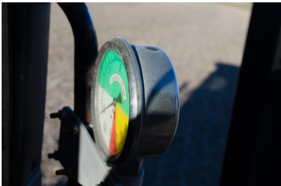
Foto 9. Manómetro de la pulverizadora con tamaño, posición y escala adecuada.
