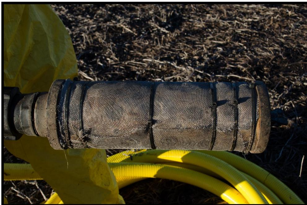
**Foto 4. Filtro de Carga en buen estado. Malla demasiado grande.**
